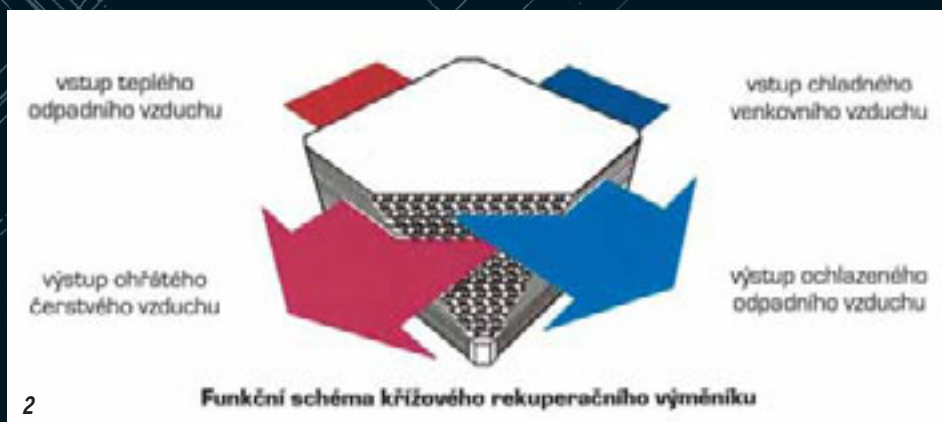
2 Princip konstrukčního řešení křížového rekuperačního výměníku
