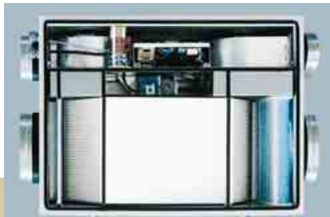
Obr. 5 Moderní koncepce větrací jednotky s rekuperací tepla s protiproudým výměníkem s účinností 90 % a výkonem až 330 m 3 /h
