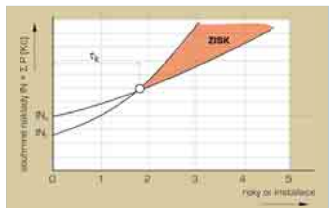
Obr. 12 Časový průběh nákladů IN + ΣP (při rostoucích cenách energií)
