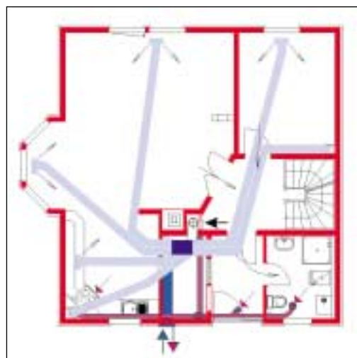
Pôdorysná schéma podlahových a podstropných rozvodov teplotvzdušného vykurovania v rodinnom dome.
