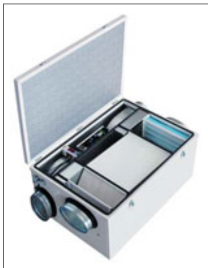
Obr. 2 Moderní koncepce větrací jednotky s rekuperací tepla s protiproudým výměníkem s účinností 90 % a výkonem až 330 m 3 /h
