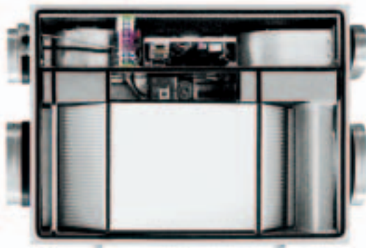
Duplex 330 EC, moderní koncepce větrací jednotky s rekuperací tepla s protiproudým výměníkem (účinnost 90 % a výkon až 330 m 3 /h)
